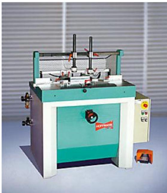
この機械は支柱/横けたなどの溝加工に使用する特殊機です。
