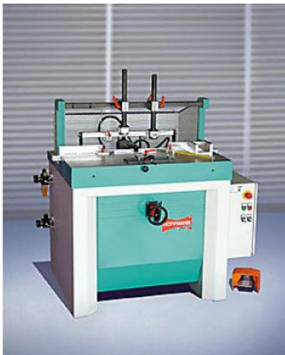
この機械は支柱/横けたなどの溝加工に使用する特殊機です。
